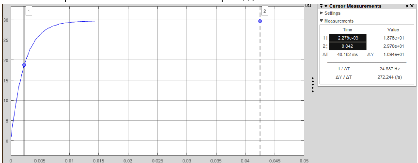
Figure 2 : réponse indicielle à un échelon d'amplitude \Omega_0= 30 rad/s avec K_p=1000 .
