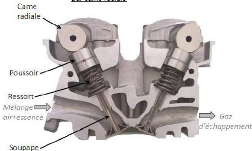
Photo du dispositif de transformation de mouvement par came radiale
