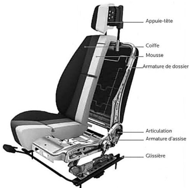
figure 2 : Composition d'un siège automobile
